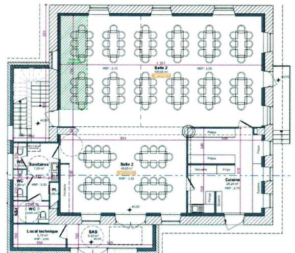
Le déplacement de l'escalier de la salle à la nouvelle extension nous permet de conserver 96,35 % de la surface utilisable de la disposition actuelle.
