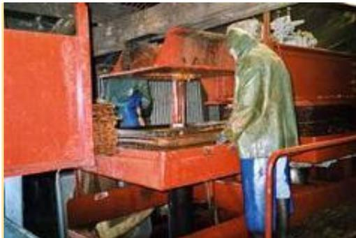
Pressage des pommes broyées dans de la toile entre des claies, dans une presse à deux maies pivotantes équipées d'un système de compression de 300 tonnes/mètre carré.
