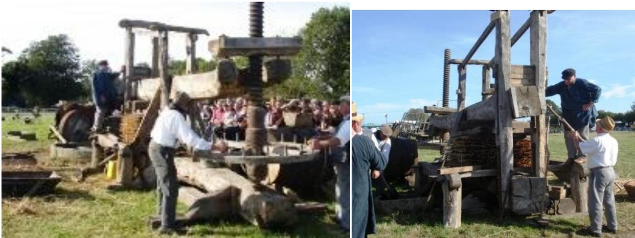
Ci-dessus, un pressoir « à longue étreinte », doté de deux longues et fortes poutres (une en bas, l'autre en haut). Le système de serrage est celui du levier. A droite, le rouet sert à régler la hauteur de l'extrémité du mouton située au-dessus de lui. Il faut de temps en temps desserrer le rouet puis le resserrer en fonction de la hauteur de la motte afin d'exercer une pression sur le mouton.
