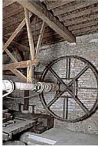
**Pressoir du clos de Tart à Morey Saint Denis (Côte d’Or).** *Détail du système à fil continu : pour ménager la roue de presse et assurer une tension régulière de la corde, celle-ci pouvait s’enrouler à une extrémité du treuil et se dérouler simultanément de l’autre.*
