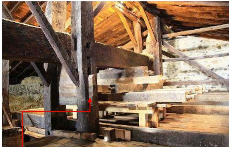
Ancien presseur à levier du pays basque à Ezkio-Itsaso. On distingue la succession des planches « aiguilles » permettant de régler la hauteur de la poutre.
