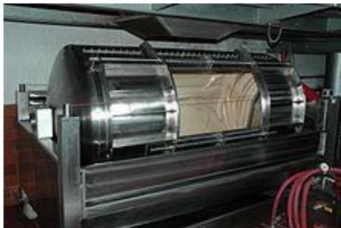
**Pressoir horizontal, hydraulique et pneumatique.**
