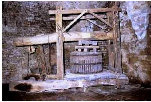
*Pressoir « Casse-coué » d'Asquins, Yonne, conservé à la mairie de Vézelay. Il est une adaptation domestique du système à levier, commandé par une corde tendue au moyen d'un treuil.*
